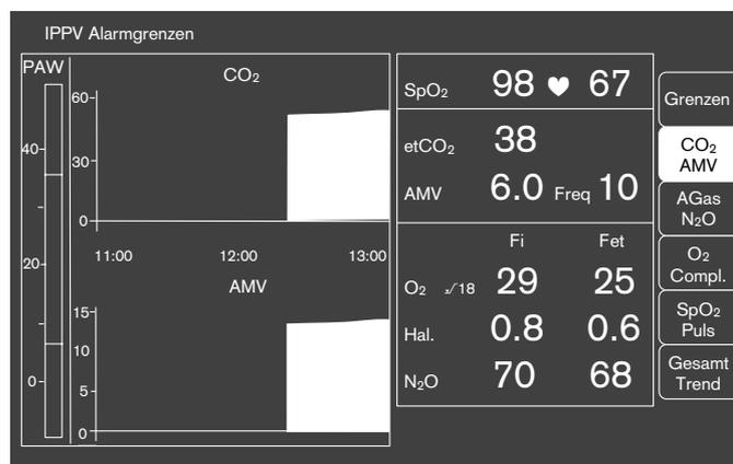
Ist das Gerät länger als eine halbe Stunde in Betrieb, ist auch die Lupenfunktion aufrufbar. Damit kann ein Ausschnitt des Zeitbereiches (mehrfach) vergrößert werden. Der Ausschnitt ist gestrichelt markiert. Ältere Zeitabschnitte sind links in der Trendseite.
